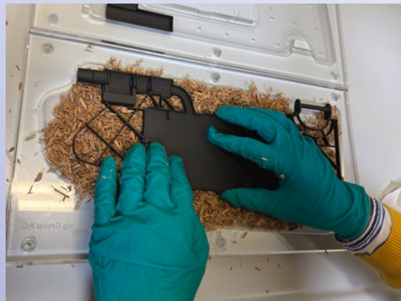
Der Einleger wird in der einen Bauteilhälfte platziert.
