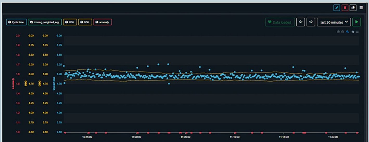
Abbildung 3: Dashboarddesign zur Erkennung von Anomalien und Drifts.
