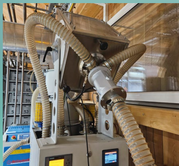
Über die beiden Schläuche oben werden Mahlgut und Neuware dem Entstaubungsmodul zugeführt. Der untere Schlauch ist mit dem Zwischenpuffer verbunden.
