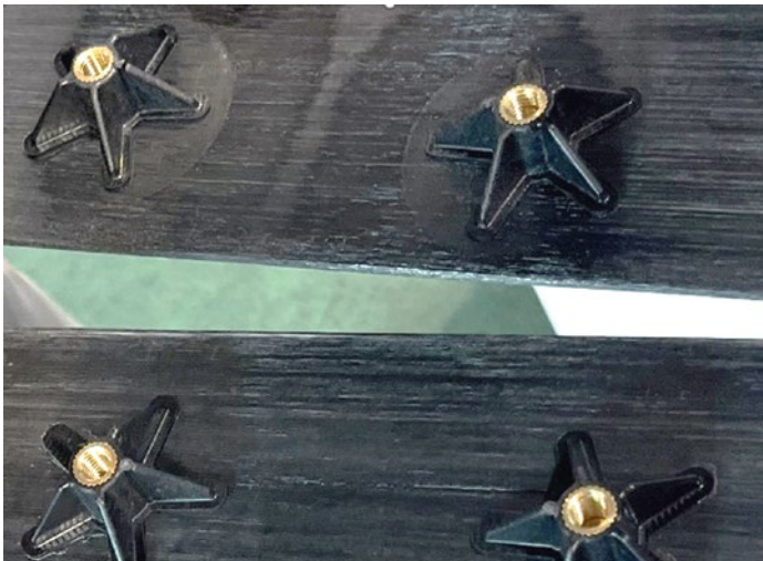
Durch Anspritzen von Bauteilen ergeben sich für Konstrukteure neue Möglichkeiten, wie hier die Schraubdomen auf schwarzem Profil aus UD-PA6-GF70.
