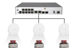
Jedes Endgerät greift auf das Netzwerk von dem AP mit dem besten Signal zu und genießt den besten Durchsatz.
