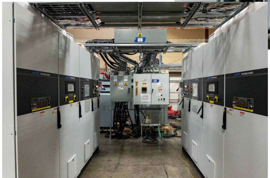
Die Cycler- und Emulationssysteme von AEC können auf einem Prüfstand das Verhalten einer realen Fahrzeugbatterie simulieren.
