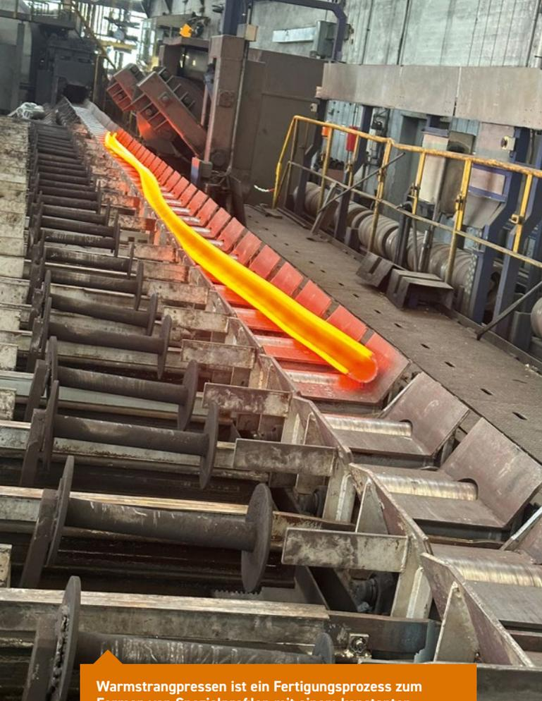
Warmstrangpressen ist ein Fertigungsprozess zum Formen von Spezialprofilen mit einem konstanten Querschnitt. Montan Stahl fertigt auf diese Weise Voll- und Hohlprofile mit komplexen Geometrien.
