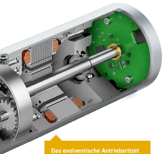
Das evolventische Antriebsritzel beim Kronenradgetriebe baut zylinderförmig und der Kontakt zwischen Ritzel und Abtriebsrad ist ein Wälzkontakt, es treten kaum Reibungsverluste auf.
