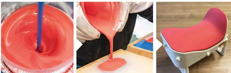
Prozessschritte zur Herstellung nachgebildeter Muskelgewebe auf Basis eines PVC-Plastisols für chirurgische Simulatoren.
