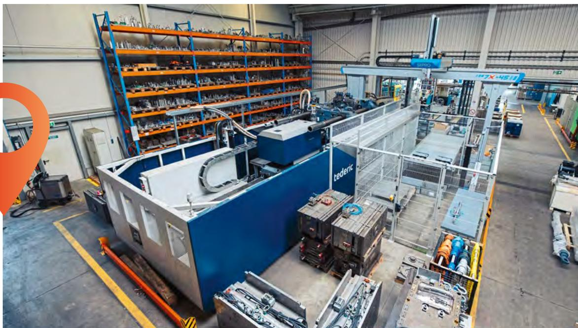
Die Wendeplattenmaschine NEO-M hat die stolzen Abmessungen 15 m Länge, 4 m Breite und mit Roboter 6 m in der Höhe.
