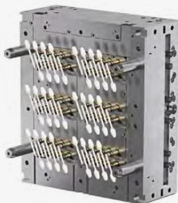
Mehrkanaliges-Heißkanalsystem Multiflow HRS mit Zylinderverschlussdüsen der Serie Tp für das Spritzgießen von Kunststofflöffeln.
