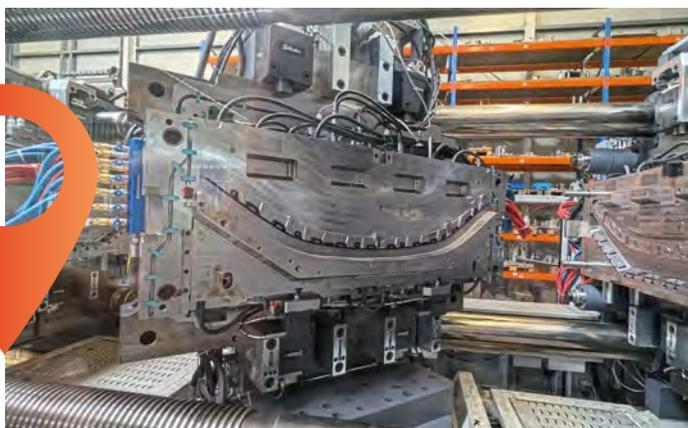
Das Schnellspannsystem von Stäubli ermöglicht schnelle Wechsel, auch solch komplexer 2K-Spritzgießwerkzeuge auf der Mehrkomponenten-Maschine NEO-M.
