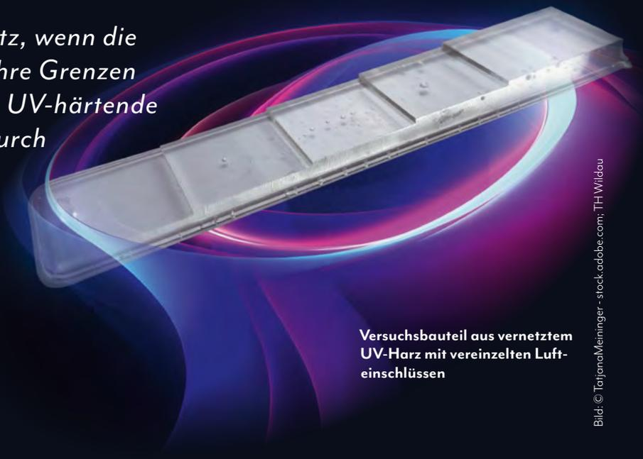
Versuchsbauteil aus vernetztem UV-Harz mit vereinzelt Luft-einschlüssen
