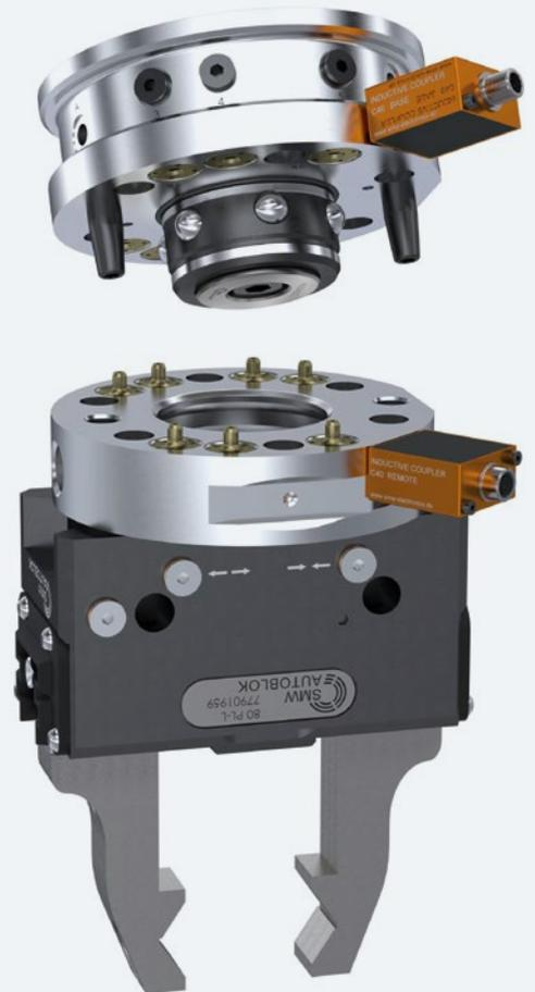
Das induktive Koppelsystem C40 Automation überträgt hier in einem Greiferwechselsystem Energie und Signale, sodass ein Sensor die Endlage oder Greifposition sicher überwachen kann. Bilder: SMW-Autoblok
