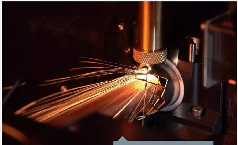
Die Anforderungen an die Fertigung von Mikrorohren in der Medizintechnik sind hoch. Stents beispielsweise müssen nicht nur millimetergenau, sondern in Mikrometern präzise bearbeitet werden, um ihre Funktion und Sicherheit zu gewährleisten.
