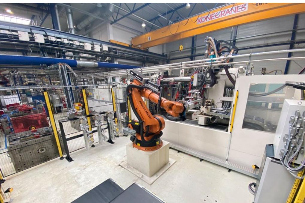
Sicher im Schutzraum mit Pilz-Radarlösung: Ein Roboter steht am Entnahmebereich der Spritzgießmaschine bei Weidplas, im Vordergrund das Transportband.
