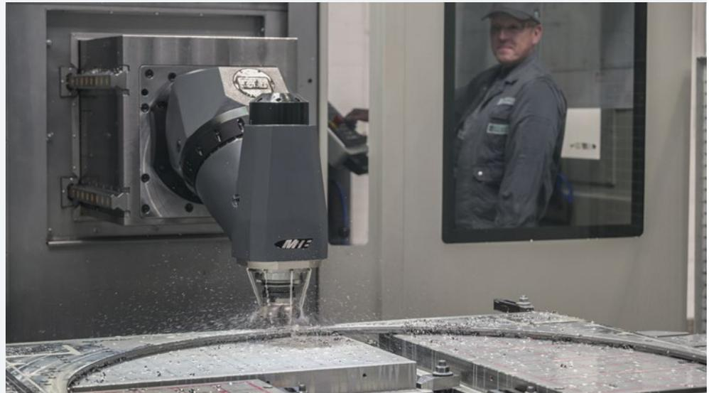
**Mit 43 kW Dauerleistung und 6000 U/min bearbeitet die FBF-S 8000 Aluminium, Stahl, Edelstahl sowie schwer zerspanbare Werkstoffe wie Duplex oder Titan.**
