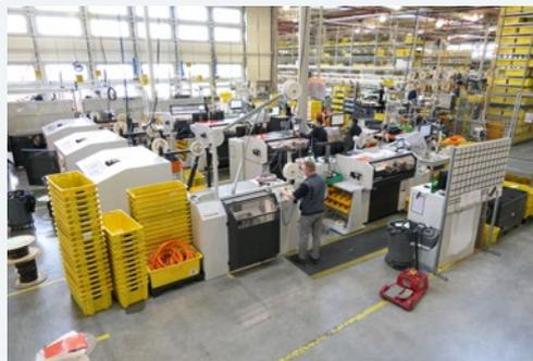
Durch Automationslösungen wie Crimp-Tower und Schleifer-Linien sorgt Igus für geringere Durchlaufzeiten sowie eine höhere Produktivität und Qualität.
