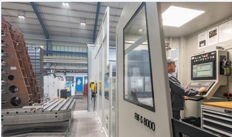
In der MTE-Fahrständerfräsmaschine fährt der Bediener mit dem Fräskopf mit und kann an der Benutzeroberfläche der Sinumerik One jederzeit korrigierend eingreifen.
