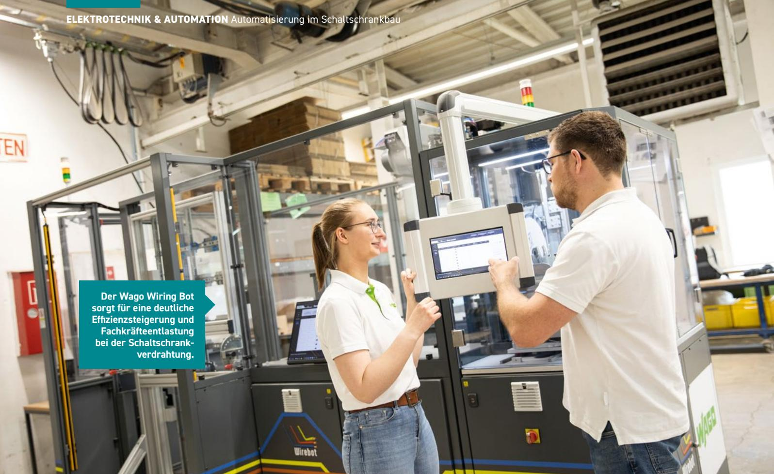
Der Wago Wiring Bot sorgt für eine deutliche Effizienzsteigerung und Fachkräfteentlastung bei der Schaltschrankverdrahtung.
