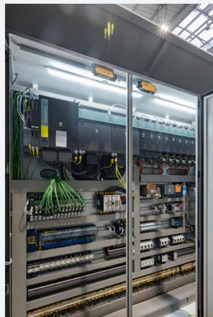
Herzstück der FBF-S 8000 ist eine leistungsfähige Sinumerik One Werkzeugmaschinensteuerung.
