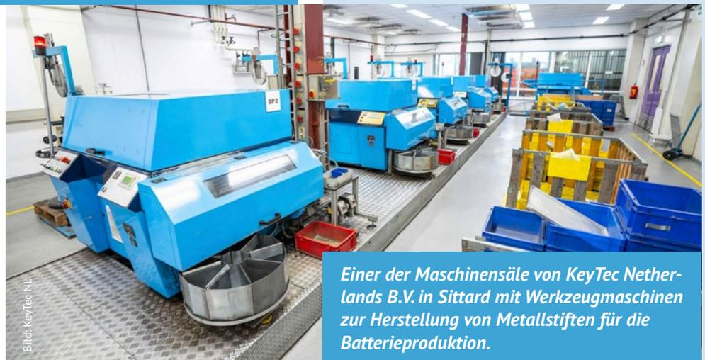
*Einer der Maschinensäle von KeyTec Netherlands B.V. in Sittard mit Werkzeugmaschinen zur Herstellung von Metallstiften für die Batterieproduktion.*
