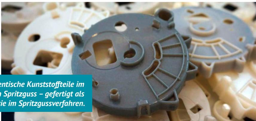
*Serienidentische Kunststoffteile im technischen Spritzguss – gefertigt als Kleinserie im Spritzgussverfahren.*
