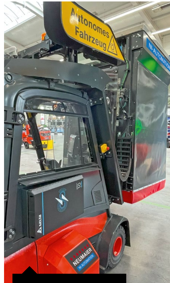
Deltas induktives 10kW Ladegerät kommt bei diesem autonomen Outdoor-Stapler FE 616 zum Einsatz.
