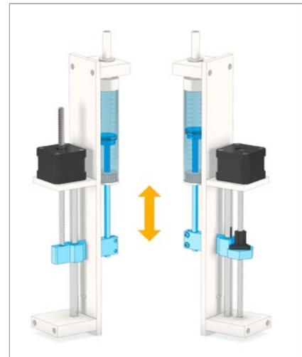
**Bild 2:** Dieses Achssteuerungssystem veranschaulicht, wie ein Kollmorgen-Schrittmotor mehrere Thomson-Gewindetribsen für eine Fluidpumpe antreiben könnte. Die Konfiguration liefert mehr Pumpendruck, reduziert den Platzbedarf und dosiert das Fluid extrem präzise.
