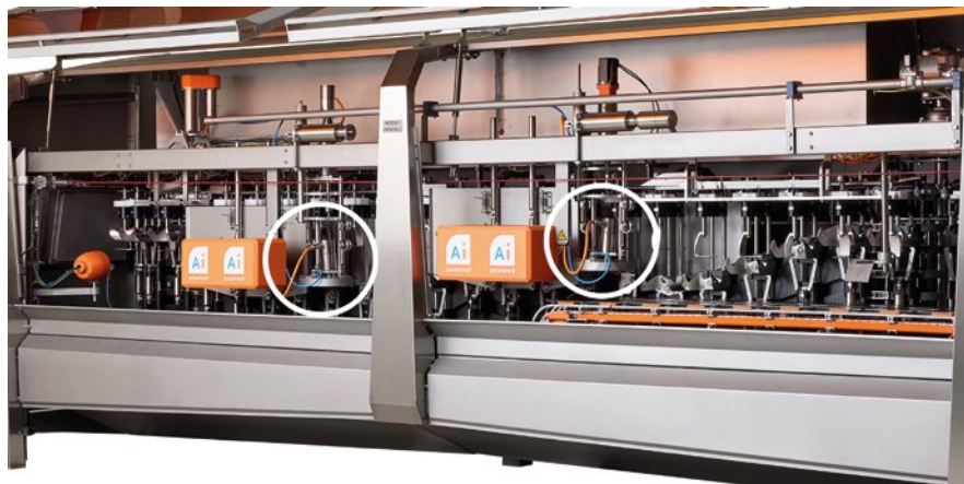
Insgesamt sieben Motoren (im Kreis) je Maschine ermöglichen eine exakte Positionierung der zu verarbeitenden Produkte.
