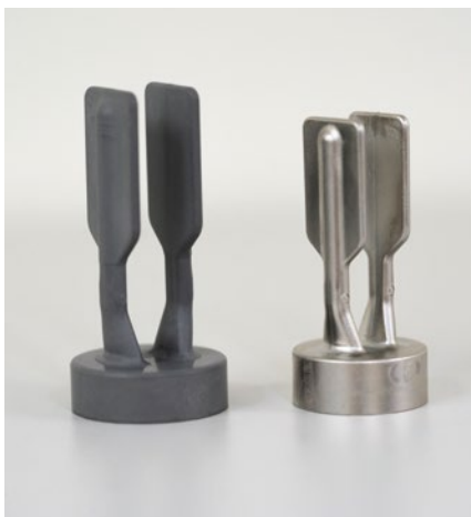
Beim MIM-Verfahren wird das Metallteil mittels Spritzgussverfahren gefertigt und erhält durch den Sintervorgang seine endgültige Größe und Dichte.
