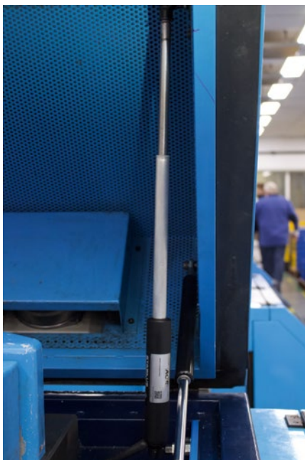
An den Hauben der Werkzeugmaschinen arbeiten Aktuatoren und Industriegasfedern Hand in Hand.
