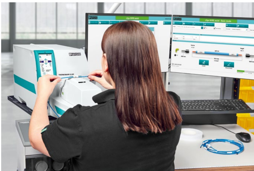
Die Werkerassistenz-Software clipx Wire assist steuert Geräte und Drucksysteme für eine effiziente und qualitativ hochwertige, teilautomatisierte Leitervorbereitung.
