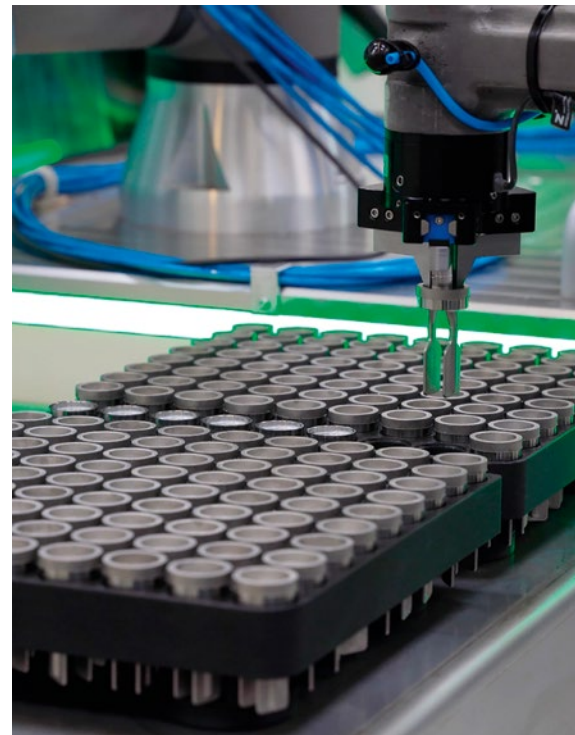
Für die Bearbeitung der Werkstücke kommt wieder ZiMo zum Einsatz. Dank des modularen Aufbaus lässt sich die Roboterzelle schnell mit zwei Greifern der Serie GPD5000 ausstatten.
