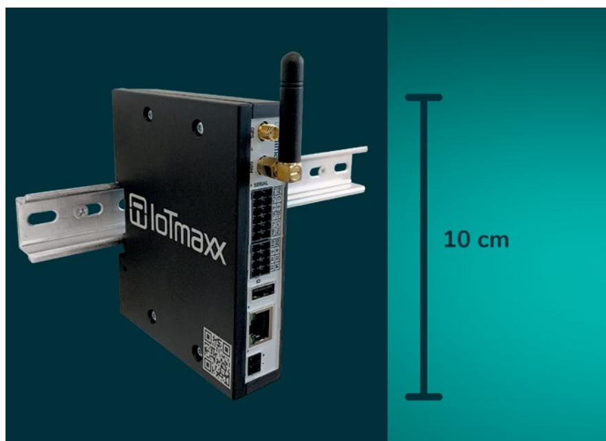
Die frei programmierbaren IoT-Mobilfunk-Gateways maxx GW4100 belegen nur wenige Zentimeter auf der Hutschiene.
