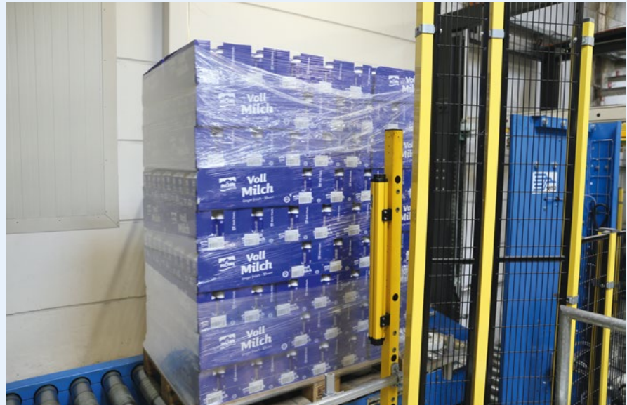
Im Bereich Food and Beverage ein relevanter Faktor: Die erweiterte Diagnosefähigkeit der IOLS-Sensoren ermöglicht beim Einsatz von Lichtgittern eine vorausschauende und vorbeugende Wartung.
