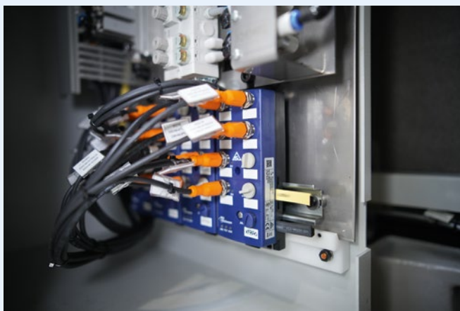
Die Entscheidung für ASi und ASi Safety (im Bild) sowie die Tatsache, dass beim Einsatz von AS-Interface für Sicherheits- und Standardapplikationen eine gemeinsame Infrastruktur verwendet werden kann, hat für Schütte viele Vorteile.
