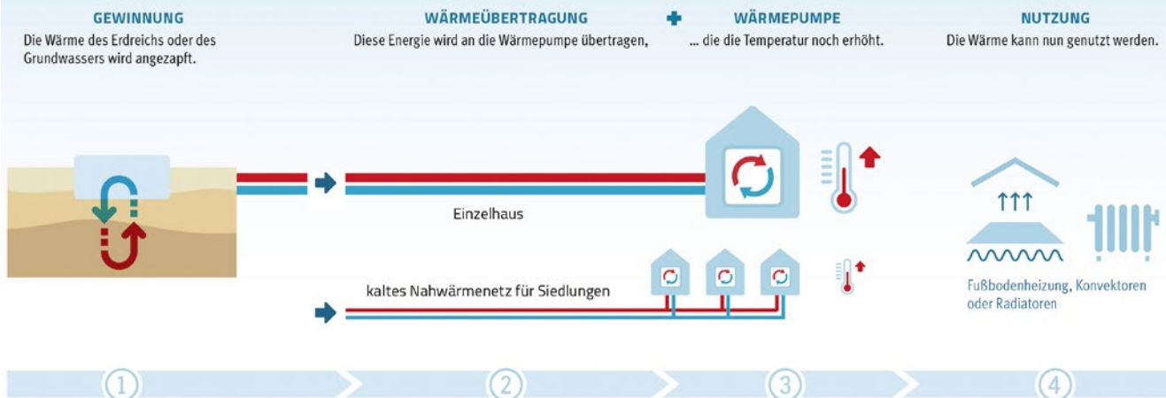
Das Prinzip der Oberflächennahen Geothermie. Bild: BVG, Susann Piesnack
