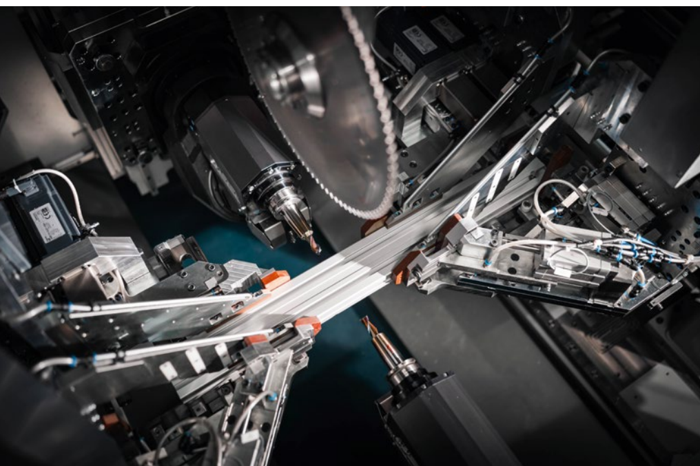
Ein in der servomotorischen Aufspannung befindliches Profil. Es lässt sich von den beiden sich gegenüberliegenden 5-Achs-Fräsköpfen gleichzeitig bearbeiten. Oben befindet sich zudem eine Säge.
