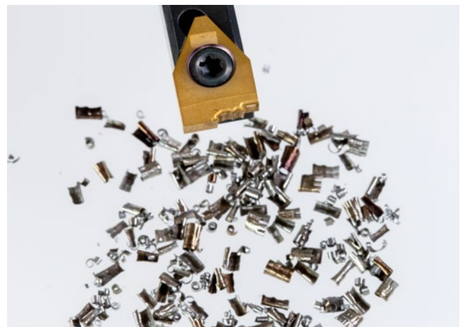
Das Formstechen mit gelaserten simturn FX Schneideinsatz erzeugt ein deutlich besseres Spanbild. Kurze Späne und weniger Wärmeeintrag durch einen geringeren Schnittdruck bieten eine höhere Prozesssicherheit und in der Regel auch längere Standzeiten.
