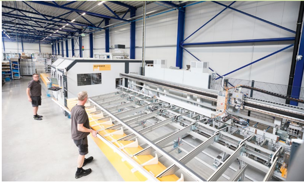
Kundenbeispiel: Die WIRUS Fenster GmbH & Co. KG in Rietberg nahm im April 2023 in einer neu errichteten Halle dieses Aluminiumprofil-Durchlaufzentrum in Betrieb. Es umfasst ein sechsspindeliges Ringmodul, eine 4-Achs-Schwenksäge von vorn sowie eine mit einem Werkzeugwechsler ausgestattete Kämpferkonturfäse.
