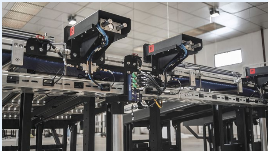
Über die selbstkonfigurierenden ASI-5 E/A Module BWU4231 von Bihl+Wiedemann werden optische Sensoren und pneumatische Aktuatoren für die Ausschleusung von Paketen eingebunden.
