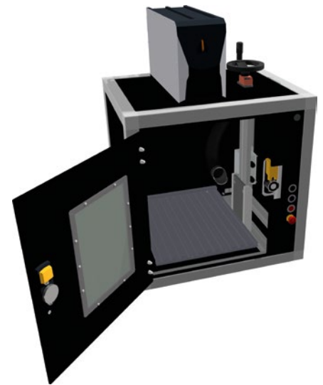
Universal Laserbeschriftungsplatz ULP 360-S: Der Tisch mit den zu gravierenden Bauteilen bewegt sich in der Höhe über eine schmierfreie Linearführung der Serie drylin SLW-1660 mit Spindelantrieb und Handkurbel.
