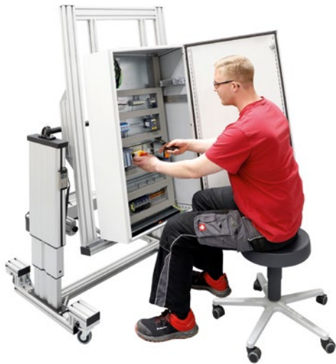
Höhe wie Neigung der Arbeitsfläche können stufenlos auf den Monteur und den Arbeitsschritt angepasst werden.
