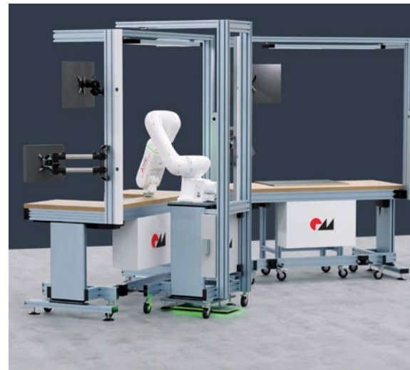
Mit Assistenzsystemen bis hin zum Cobot – hier der mobile Cobot-Wagen RK Easy Cuve – kann der Hersteller Arbeitsplätze zur teilautomatisierten Montagelinie ausbauen.
