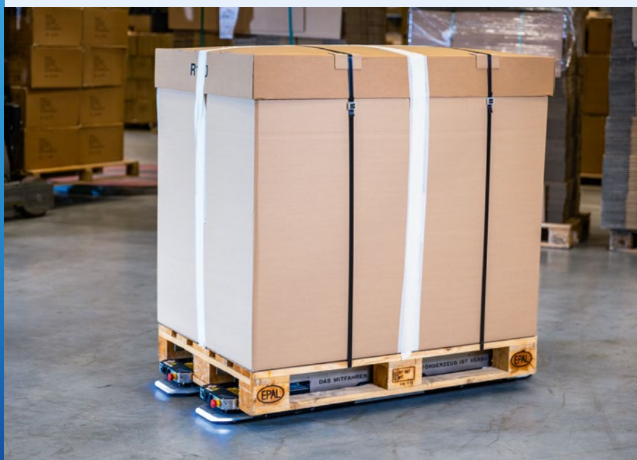
Die Filics Unit zeichnet sich vor allem durch die flache und kompakte Bauweise aus, die Kufen sind nur unwesentlich länger als eine Europalette. Dadurch wird eine Automatisierung auch in sehr engen, organisch gewachsenen Gebäuden möglich.
