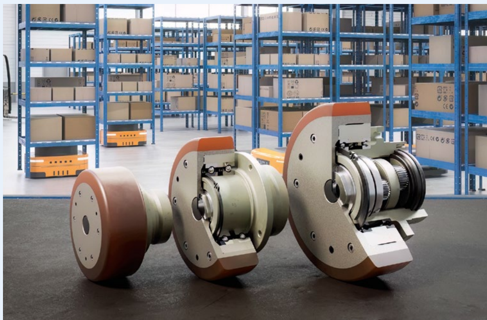
Die Plattform-Nabengetriebe von Framo Morat sind in drei Baugrößen in jeweils ein- und zweistufiger Ausführung erhältlich. Das NG250 (links) kann bis zu 250 kg Traglast pro Rad abdecken, das NG500 (mittig) bis zu 500 kg. Durch das neue NG750 (rechts) wurde der Radiallastbereich auf bis zu 750 kg pro Rad erweitert.
