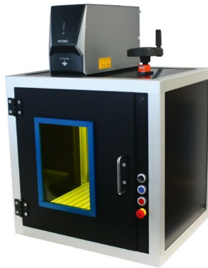
Universal Laserbeschriftungsplatz ULP 360-S: Der Tisch mit den zu gravierenden Bauteilen bewegt sich in der Höhe über eine schmierfreie Linearführung der Serie drylin SLW-1660 mit Spindelantrieb und Handkurbel.
