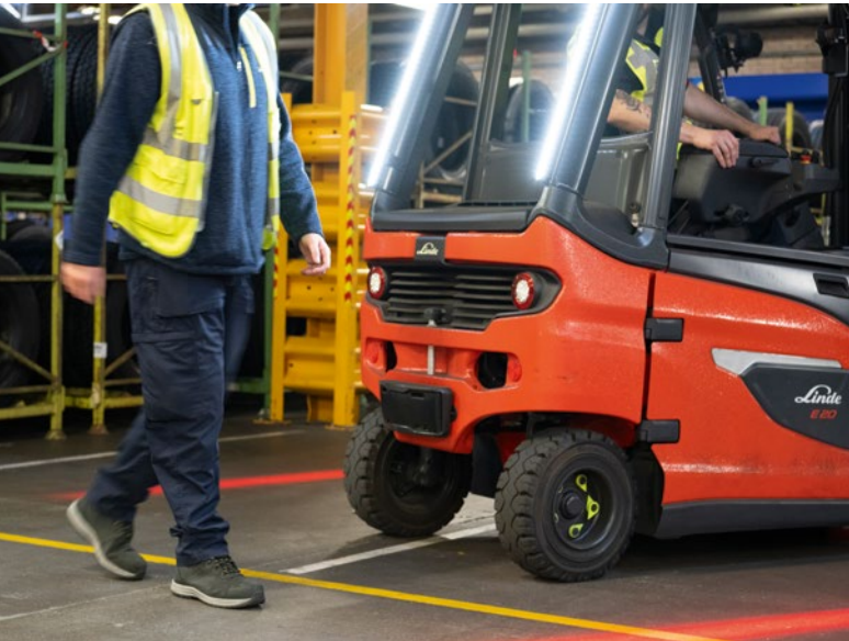
Erkennt der Linde Reverse Assist Radar während der Fahrt oder beim Anfahren ein Hindernis, bremst es den Stapler mit maximal 3 m/s 2 bis zum Stillstand ab.
