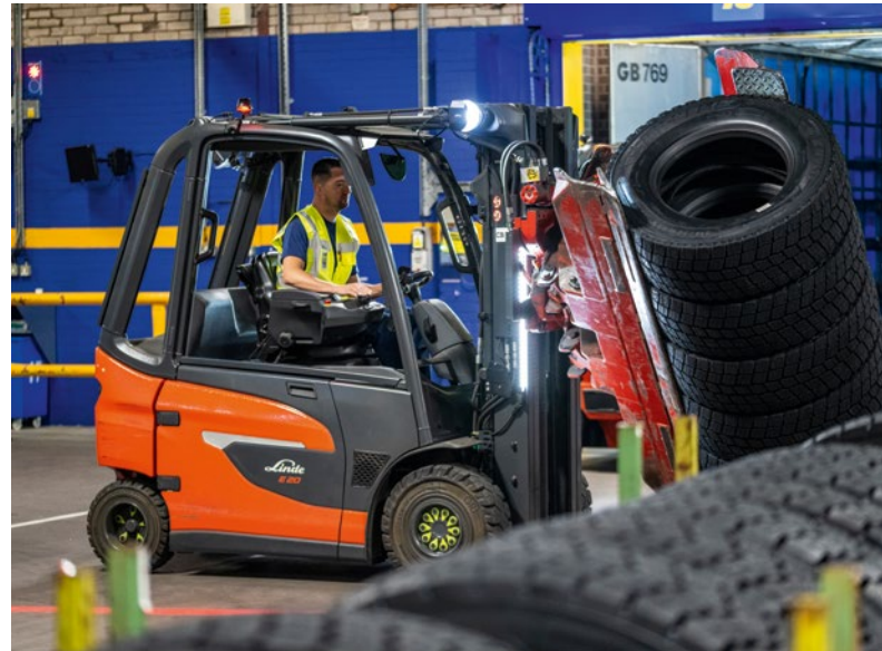
Der Transport der großen Nutzfahrzeugreifen erfolgt per drehbarer Reifenklammer und erfordert von den Beschäftigten in der Logistik höchste Konzentration.
