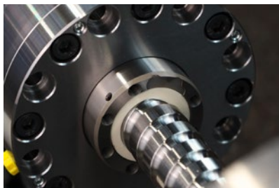
Kugelgewindemutter: Axiales Umlenkstück von außen.
