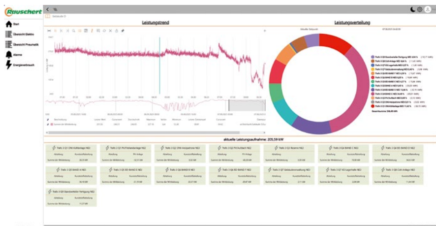
Das implementierte Energie-Monitoring-Tool zeigt den Energieverbrauch der Fabrik und der einzelnen Gebäude im Überblick. Bilder: Paul Rauschert Steinbach GmbH
