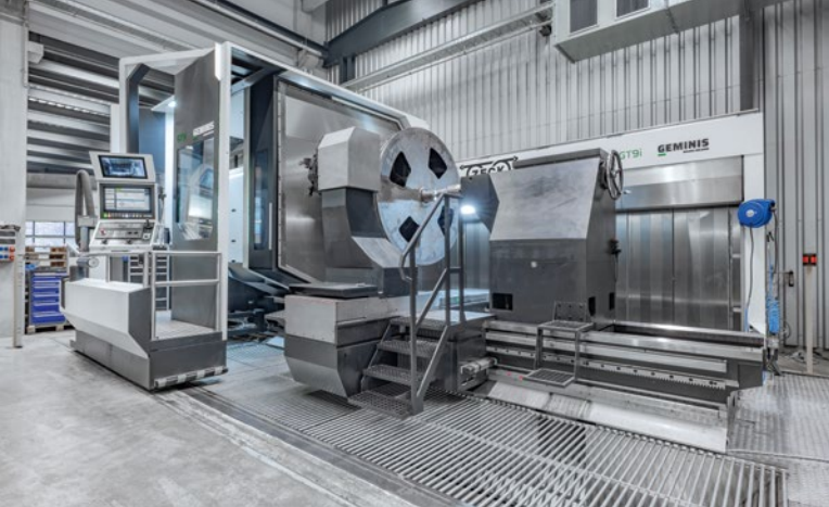
Auf der Geminis GT9i können Rillenräder mit einem Durchmesser von bis zu 2900 Millimetern hocheffizient bearbeitet werden. Bild: Siemens
