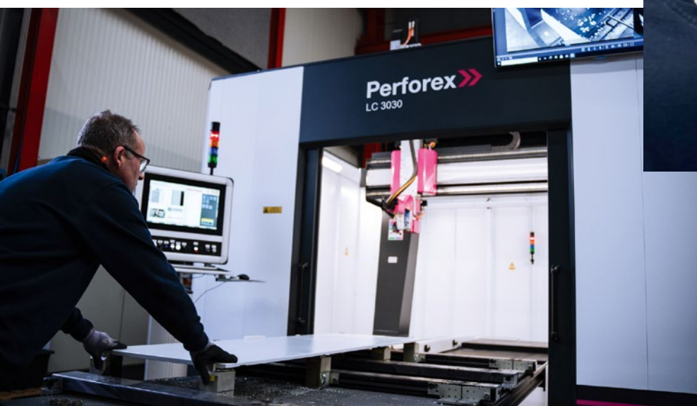
Die Perforex-Anlage übernimmt bei Röring von Anfang an die automatisierte Laserbearbeitung von Schaltschrankkomponenten.
