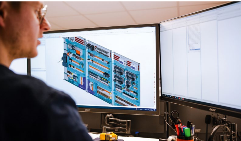
Für die 3D-Schaltschrankplanung nutzen die Röring Elektrokonstrukteure Eplan Pro Panel.
