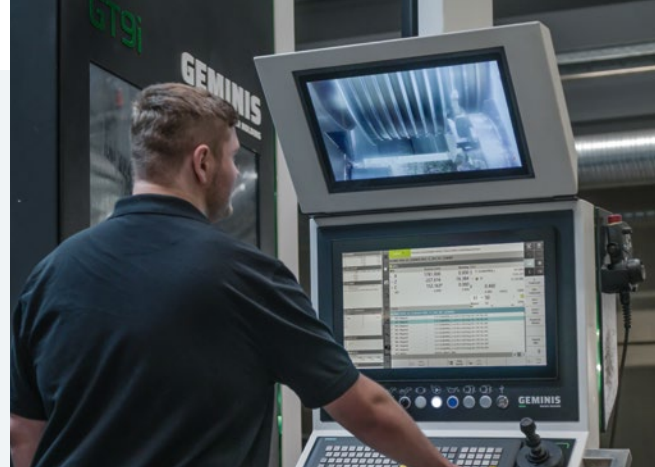
Auf der mitfahrenden Bühne hat der Maschinenbediener den gesamten Drehprozess im Blick und ist dabei gut vor Spänen geschützt. Bild: Siemens
