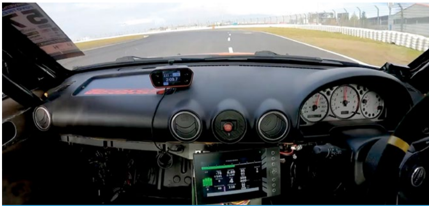
Die ermittelten Daten überträgt TWIIST in Echtzeit an ein Display im Cockpit, hier in der unteren Mitte zu sehen.
