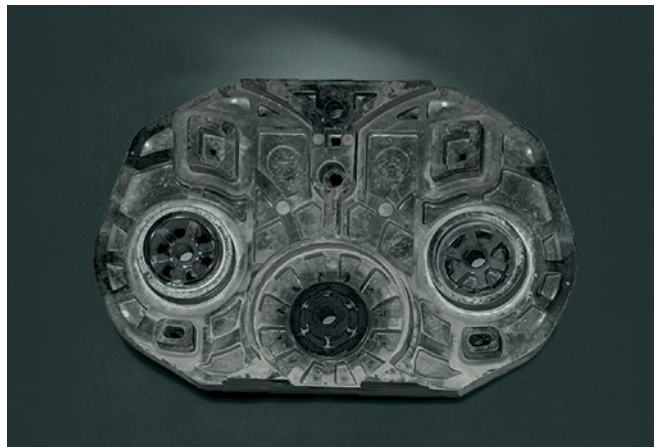
Entwicklungsbeschleuniger 3D-Scanning: Statt jede Optimierungsstufe mit aufwendigen taktilen Messreihen zu verifizieren, können erste Muster vollständig gescannt und automatisch mit den CAD-Sollgeometrien abgeglichen werden.
