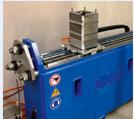
Prüfstandtest aller Kleinststoßdämpfertypen der Kleinserie von ACE vor ihrem Einsatz in Handlingsystemen für die Halbleiter-Produktion.
