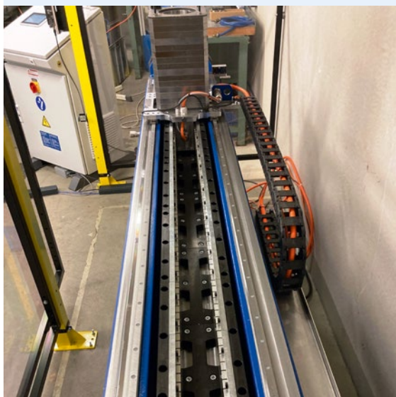
Neuer Horizontalprüfstand von ACE mit hochwertigem elektrischem Antrieb sowie mit Linearführungen, Signalprozessoren und Kraftmessern auf neuestem Stand der Technik. Bild: ACE
