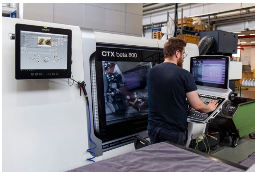
Der Maschinenpark von Berg Spanntechnik umfasst 18 Dreh- und Fräszentren sowie Schleifmaschinen. Die Datenvisualisierung erfolgt über InfoPoint VM direkt an den NC-Maschinen.
