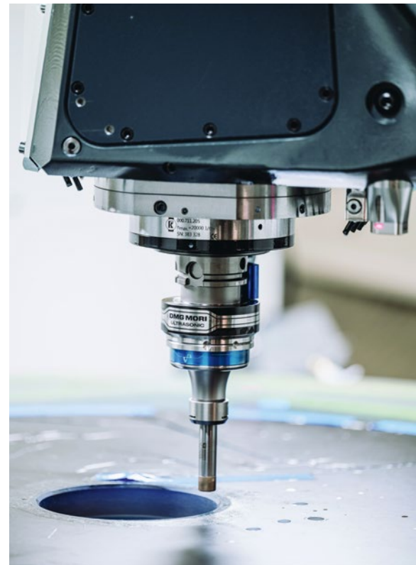
Bei der Bearbeitung schwingt das Diamantwerkzeug entlang seiner Achse mit hoher Frequenz und geringer Amplitude. Bilder: DMG Mori
