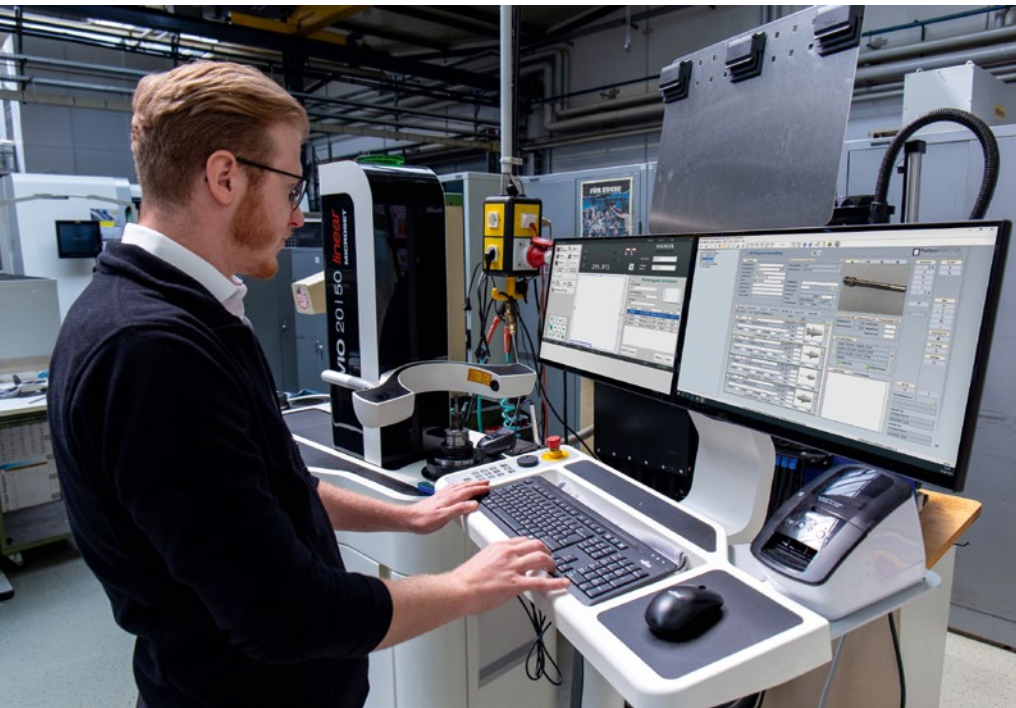
Das Werkzeugvoreinstellgerät von Haimer tauscht Daten im Prozess eingebunden aus: vom Rüstzentrum mit dem Toolmanagement-Modul ToolDirector VM.
