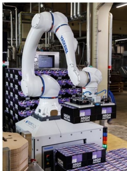
Der Cobot entnimmt die Trays aus dem vorge-schalteten Packer, setzt sie auf Paletten um und fügt selbstständig Karton-Zwischenlagen ein. Bilder: Yaskawa Europe
