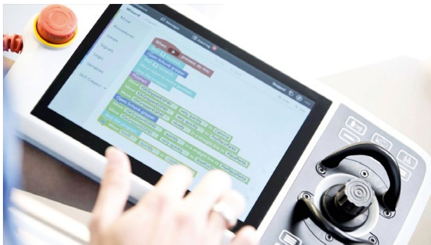
Wizard Easy Programming nutzt einen Drag-and-Drop-basierten No-Code-Programmierungsansatz, der darauf ausgelegt ist, die Entwicklung von Roboteranwendungen zu vereinfachen.
