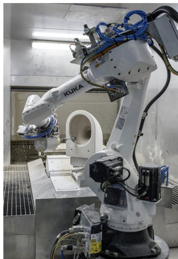
Der Roboter reinigt auch Stellen, die der Kunde niemals sehen wird. Bild: Kuka
