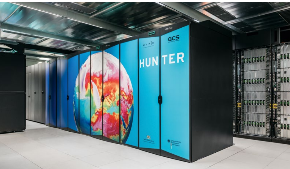
Der Supercomputer Hunter zog im Januar 2025 ins HLRS ein. Seine theoretische Spitzenleistung liegt bei 48,1 Petaflops – er ist damit fast doppelt so schnell wie sein Vorgänger Hawk.
