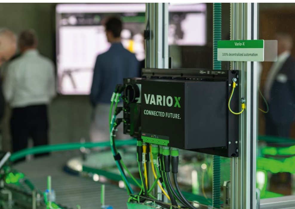
Power für die dezentrale Automatisierung: Im System Vario-X von Murrelektronik sorgt der MQ15-Steckverbinder für eine schnelle und zuverlässige Energieversorgung direkt im Feld.
