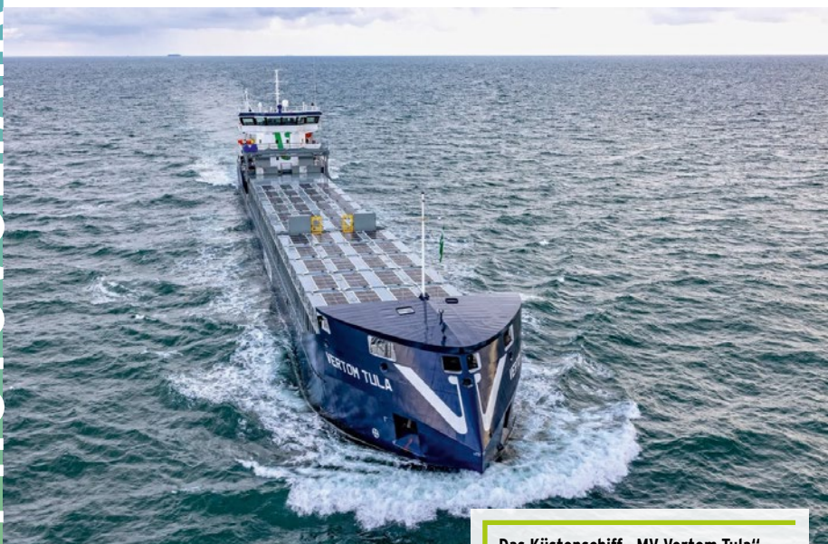
Das Küstenschiff „MV Vertom Tula“ versorgt über ein seetüchtiges Solar-energiesystem unter anderem seine Bordsysteme mit Strom. Bilder: Wattlab
