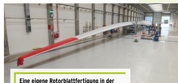
Eine eigene Rotorblattfertigung in der Türkei erstellt Enercon für das Modell „E-175 EP5 E2“. Bild: Enercon
