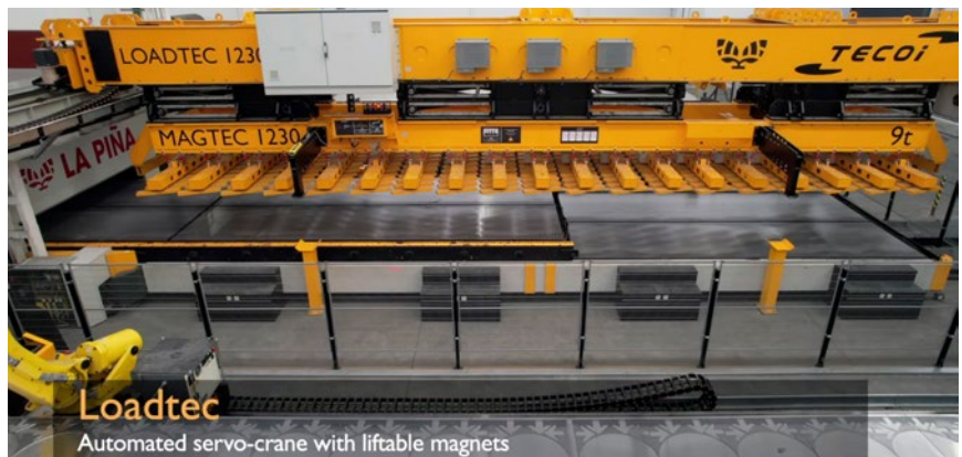
Loadtec von Tecoi: Nach dem Schneiden transportiert ein servogesteuerter Kran das geschnittene Material in einen Bereich, wo Roboterarme übernehmen, die von Lantek Expert gesteuert werden.
