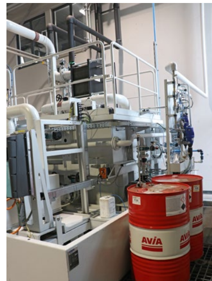
Aus den roten Fässern wird der mineralölfreie, wassermischbare Bantleon-KSS Avilub Metacool ETA automatisch nachdosiert.
