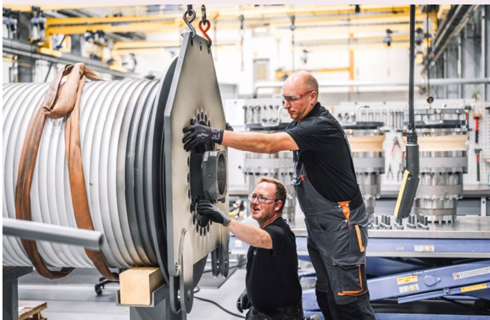
Zwei Mitarbeiter bei der Endmontage einer Seilwinde.
