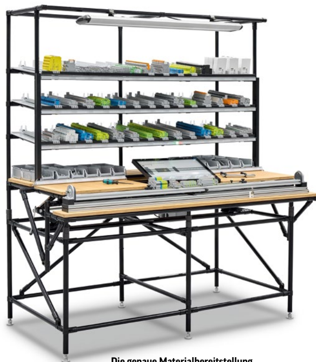
Die genaue Materialbereitstellung und digitale Prozessführung bildet die Grundlage für effizientere Bestückungsprozesse im Schaltschrankbau.
