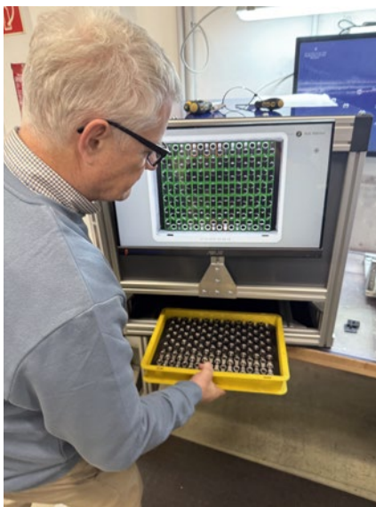
KI-gestützter Prüfstand: Geordnete Bauteile in der Eurobox während der optischen Inspektion.
