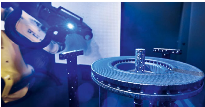
Eine optische 3D-Messmaschine der ScanBox Serie 4 führt die automatisierte Qualitätsprüfung einer Bremsscheibe durch.
