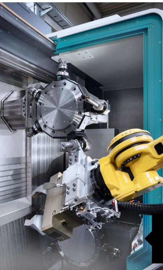
Der Roboter übernimmt den automatisierten Werkzeugwechsel am Revolver.
