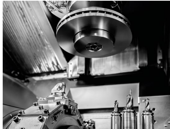
Die CNC-gestützte Fertigung bei Breyden zeigt den Blick in das Innere einer Bearbeitungsstation mit Werkzeugrevolver und Bohrmagazin.
