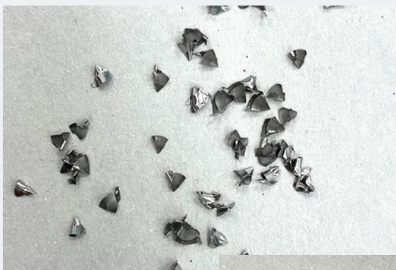
Kurze „Chips“ als Nutzenbeleg für kontrollierten Spanbruch.
