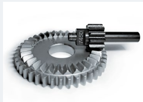
Kronenradgetriebe zeichnen sich durch einen hohen Wirkungsgrad, eine kompakte Bauweise, eine einfache Lagerung und eine kostengünstige Montage aus.
