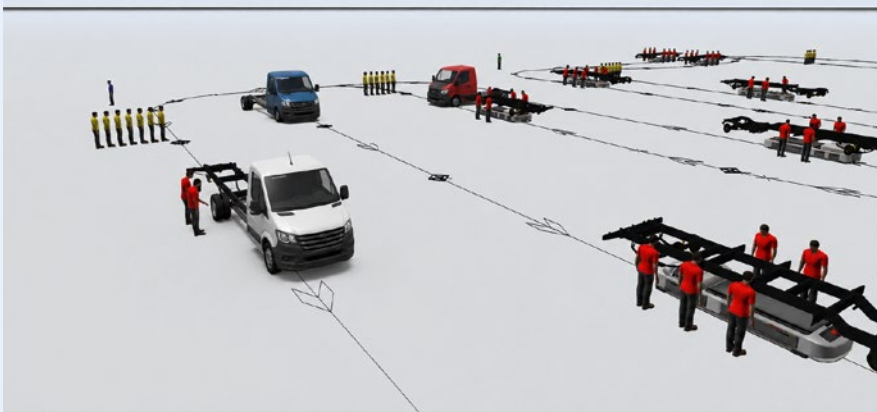
Das diskrete Simulationsmodell berücksichtigt Stationen, Materialfluss, Personalressourcen, Laufwege und betriebliche Restriktionen.
