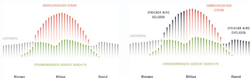
Eigenverbrauchsoptimierung ohne (links) und mit Batteriespeicher (rechts).
